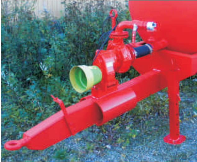
Rovatti T1-50E pumpun tiedot ulosoton pyörimisnopeudella 540 r/min
